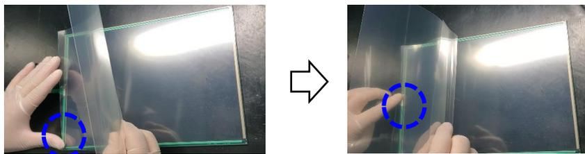
2. 1の状態から FV フィルムの短辺の中央から矢印の方向へ貼り合わせる。
