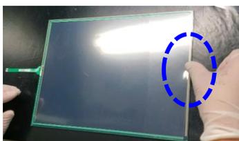
5. 4の状態から FV フィルムの短辺を中央から矢印の方向へ貼り合わせ、表面の保護フィルムを剥がします。
