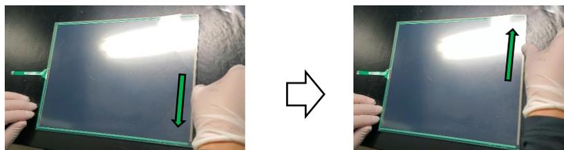
※抵抗膜製品の場合、保護フィルムをはがす際にITOフィルムに負荷がかかりますので、水平方向へゆっくりとはがしてください。
