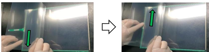
3. 最初に貼った短辺を押さえながら保護フィルムを持って気泡が入らないように FV フィルムの自重でゆっくり貼り合わせ、青丸部箇所は浮いている状態にして保護フィルムを剥がす。
